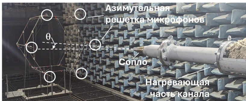
Рис. 1. Экспериментальное исследование шума турбулентной нагреваемой струи в заглушенной камере АК-2 ЦАГИ с помощью метода азимутальной декомпозиции
