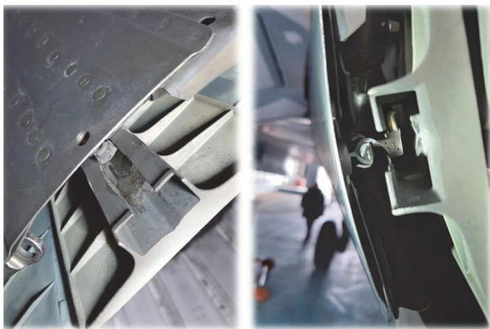
Рис. 1. Выявленный износ конструкции соплового аппарата
