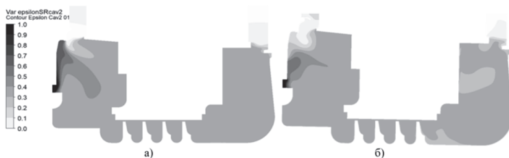
Рис. 2. Расчетная CFD-модель исследуемой турбины с полостями
