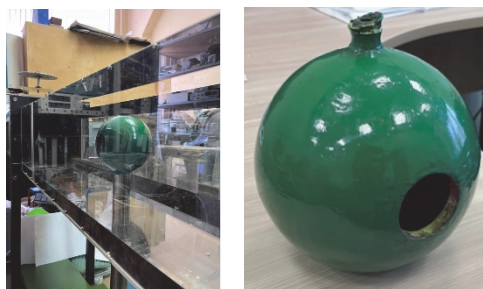
Рис. 1. Шаровой резонатор и его расположение в проточной камере аэродинамического стенда ИПФ РАН
