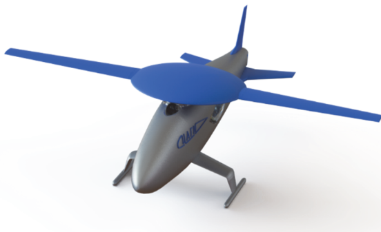
Рис. 1. Концепция ВКЛА с останавливаемым в полёте несущим винтом-крылом
