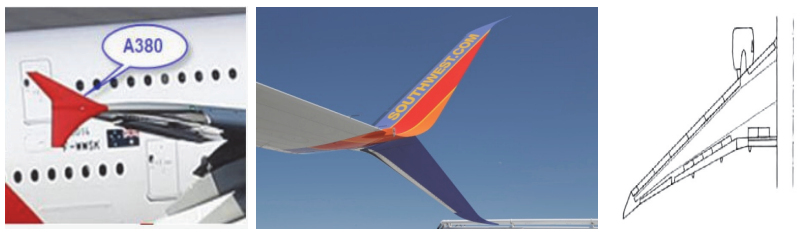
Рис. 1. Примеры законцовок крыла – слева направо: «концевая шайба», «винглет», «шарклет»
