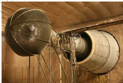
Рис. 1 - Модель вентилятора CRTF с противотурбулентным устройством, установленная в безэховой камере акустического стенда
