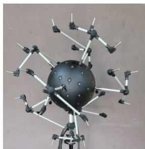
Рис. 1. Общий вид сферической микрофонной решетки МАИ (расширенная конфигурация, внешний диаметр сферы 80 см, 78 микрофонов. Рабочий частотный диапазон 200-10000 Гц)
