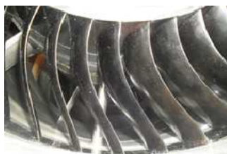
Рис.7. Модель однорядного двухконтурного вентилятора с наклоном лопаток СА. а) - наклон лопаток против часовой стрелки (вариант 1); б) - наклон лопаток по часовой стрелке (вариант 2)
