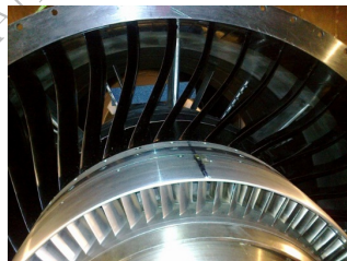
Рис.7. Модель однорядного двухконтурного вентилятора с наклоном лопаток СА. а) - наклон лопаток против часовой стрелки (вариант 1); б) - наклон лопаток по часовой стрелке (вариант 2)
