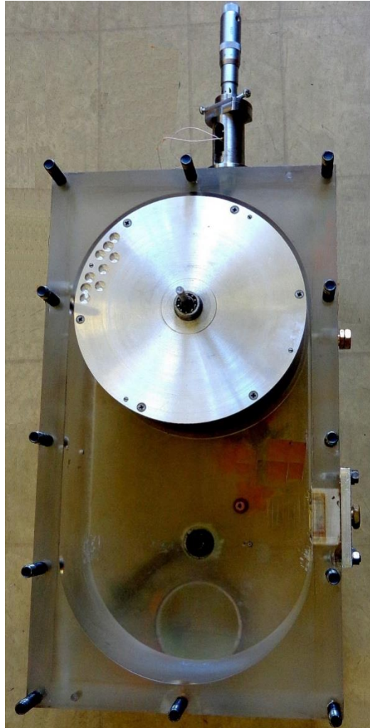
1 – Стенд для моделирования течения Куэтта
