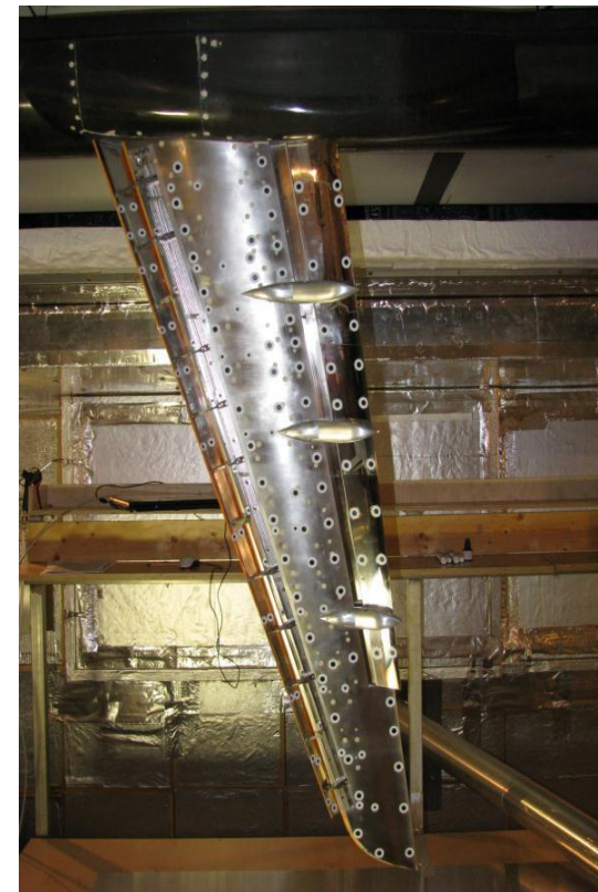
Маркеры STP для измерения деформаций в эксперименте
