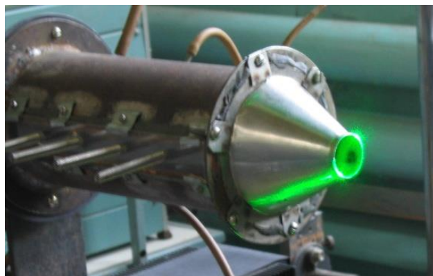
Экспериментальная установка: 1 – цилиндрическая труба, 2 – завихритель, 3 – сопло, 4 – форсунка, 5 – датчик, 6 – оптическое окно, 7 – сопло
