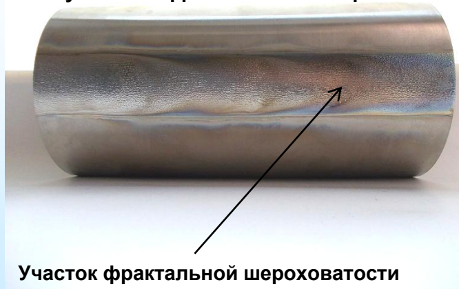
Фотография цилиндрической модели с участком фрактальной поверхности
