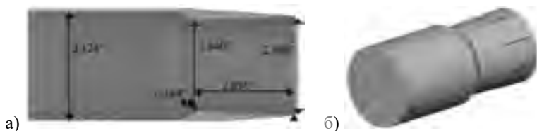
Рис. 1. а) Геометрия сопла (размеры указаны в дюймах), б) расположение щелей для выхода синтетических струй
