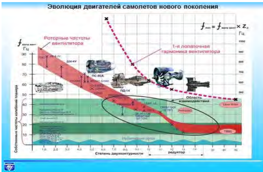
Рис. 1. Частоты вращения вала вентилятора двигателя и собственные частоты планера самолета (слева), лопаточные частоты вентилятора (справа) в процессе эволюции двигателей [4]
